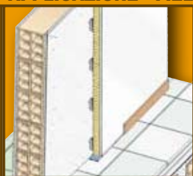
CONTROPARETI IN GESSORIVESTITO INCOLLATE BONDED PLASTERBOARD FALSE-WALL
