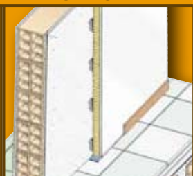
CONTROPARETI IN GESSORIVESTITO INCOLLATE BONDED PLASTERBOARD FALSE-WALL
