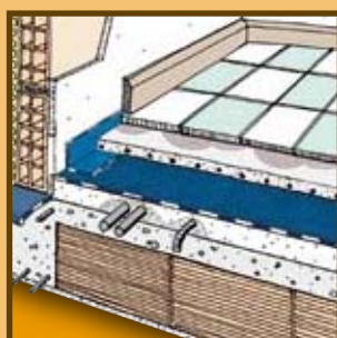
Isolamento acustico dei pavimenti dai rumori da calpestio
